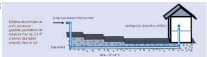
Principe du puits provençal
