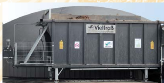
BENNE RÉCEPTRICE ET D'INTRODUCTION PAR VIS SANS FIN DANS LE DIGESTEUR DES DÉCHETS SOLIDES (FUMIERS, DÉCHETS ALIMENTAIRES, TONTES)
