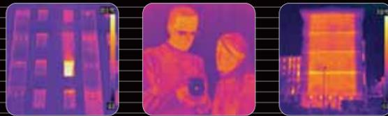
La thermographie est une technique de cartographie des températures de surface des parois ou de tout autre objet. Elle s'obtient par la prise de clichés photographiques en rayonnement infrarouge.
