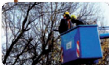
**La nacelle élévatrice** associée à la tronçonneuse permet un élagage précis des branches hautes et basses. L'outil doit être homologué et nécessite l'accréditation de l'opérateur.
