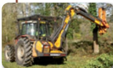
**Le lamier à scie** permet de contenir l'emprise latérale des haies par la coupe des branches de diamètre moyen. À ne pas utiliser trop fréquemment car les tailles successives conduisent à une densification des haies. L'idéal est une utilisation tous les 5 à 15 ans.
