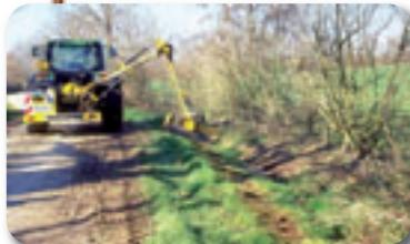
**L'épareuse à rotor** permet le débroussaillage et l'entretien des bordures et accotements de talus. Il est conseillé de maintenir une hauteur de coupe suffisante pour ne pas éroder le sol.
