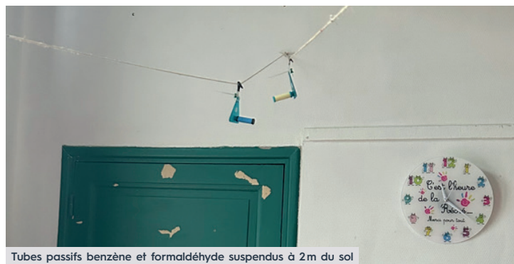
Tubes passifs benzène et formaldéhyde suspendus à 2m du sol
