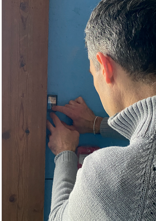
Mesure des températures intérieures dans la durée afin de détecter les marges de progrès
